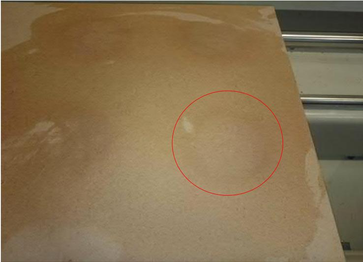
Hier wurde eine MDF-Platte nass gemacht. Prompt gab der Unterdruckwächter das Werkstück, das trocken nicht funktioniert hat, frei. Deutlich sieht man, wo die Platte durchsaut, dort wird sie schneller trocken
