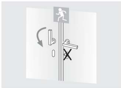
Bei Anti-Panik-Schlössern darf kein Schlüssel im Schloss stecken bleiben
