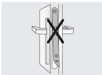
Sobald Spuren von Gewaltnutzung sichtbar sind, muss das Schloss ersetzt werden.
