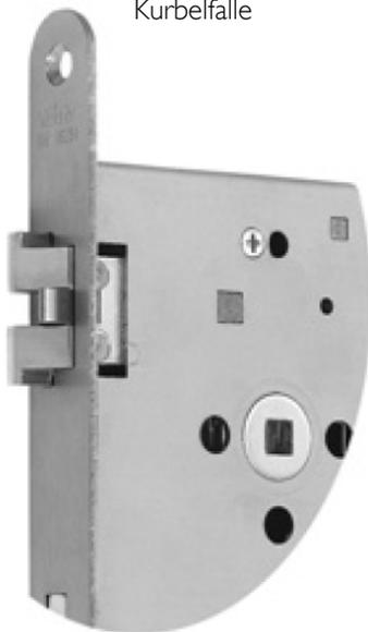
Die Kurbelfalle ist eine zweiteilige Falle, bei der der mittlere Teil auf das Schließblech oder die Stahlzarge schlägt. Dieser Teil drückt durch seine Hebelwirkung die Falle in den Schlossstulp hinein. Hierdurch wird das beim Zuschlagen der Tür hörbare Geräusch etwas gedämpft.
