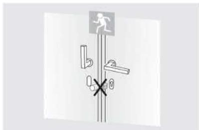
In Anti-Panik-Schlössern dürfen keine Schließzylinder mit Knauf oder Drehknopf eingebaut werden
