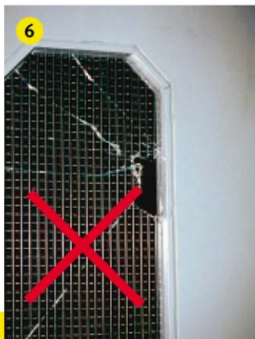
Drahtglas ist kein Sicherheitsglas!
