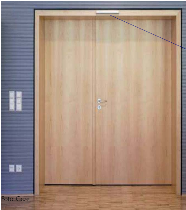
Externer Rauchschalterzentrale GEZE RSZ 6 auf der Bandgegenseite. Nur notwendig wenn der Türschließer keine Rauchschalterzentrale hat.
