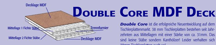
**Double Core** ist die erfolgreiche Neuentwicklung auf dem Tischlerplattenmarkt. 38 mm Tischlerplatten bestehen seit Jahrzehnten aus Mittellagen mit einer Stärke von ca. 31mm. Das sind keine Stäbe sondern Kanthölzer! Leider verhalten sich 38mm Tischlerplatten auch so!
